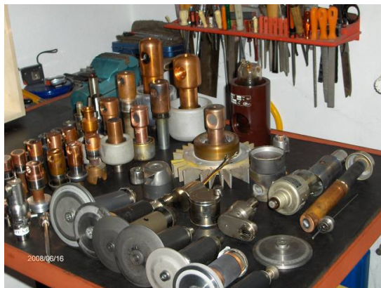
Obr. 5. Fragментy poškozených rentgenek
