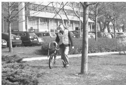
Praktické provádění inspekce potrubí uloženého v zemi
