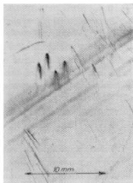
Obr.2 Poruchy v monokrystalech křemene
