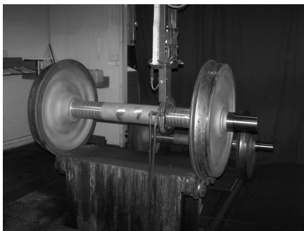
Rys.2 Stanowisko MT - na obrotniku część środkowa osi badana metodą magnetyczno proszkową mokrą.
