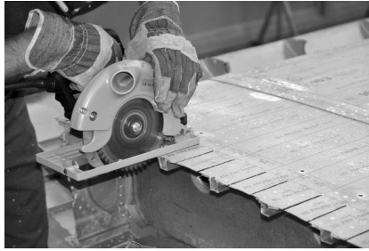
Obrázek 3 Provedení řezu při demontáži potahového plechu a podélníku Figure 3 Performance of cut at teardown analysis of metal sheet and runner
