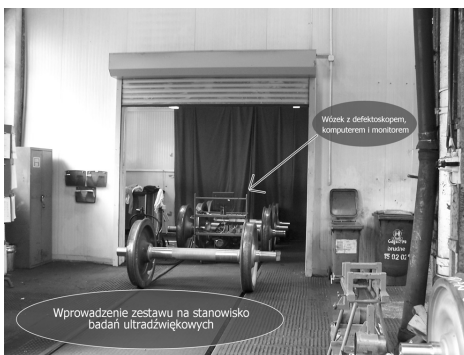
Rys.4 Badanie UT - wydzielone stanowisko ultradźwiękowych badań zestawów kołowych
