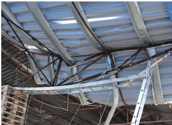
Obr. 8 Testovaná konstrukce po poslední zatěžovací fázi. Fig. 8 Tested structure after the last loading period.
