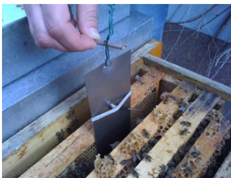
Obr. 2 Snímače Slot01-02 umístěné na desce uvnitř úlu. Foto autorů. Fig. 2 Slot01-02 sensors on the sheet metal plate in the hive interior. Photo by authors.
