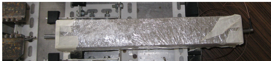
Obr.4 Aplikace metody impact-echo (vlevo – úder, vpravo – snímač)
