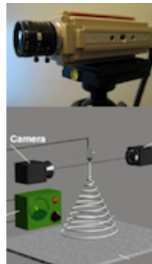
Obr. 36 a ), b) uspořádání k měření kvality povrchů, c) ultrarychlostní kamera
