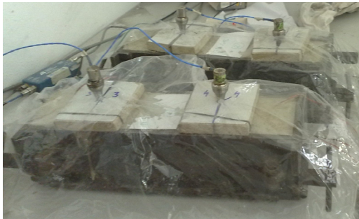
Obr. 1 Uchycení snímačů na vlnovodech při tuhnutí betonu Fig. 1 Mounting of sensors on the waveguide during concrete hardening
