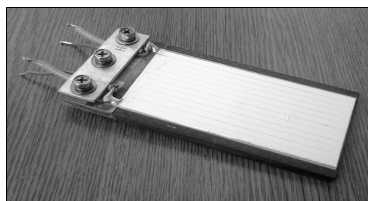
Obr. 4 Tvar a rozměry vinutí a celkový vzhled vzorku Fig. 4 Heating element shape and overall sample design
