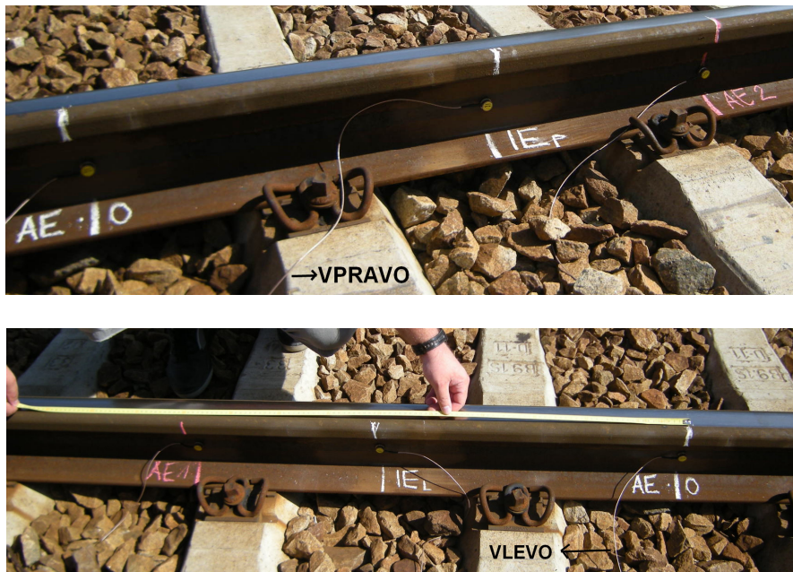
Obr. 2 Umístění snímačů na kolejnici včetně označení směru realizace mechanických impulsů
