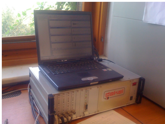
Obr. 3 Dakel XEDO AE analyzátor používán v experimentu. Foto autorů Fig. 3 Dakel XEDO AE analyzer used in the experiment. Photo by authors.
