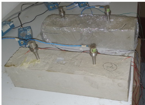
Obr. 2 Uchycení snímačů na vlnovodech při zrání betonu Fig. 2 Mounting of sensors on the waveguide during concrete curing
