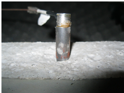
Obr.1 Umístění snímače na vlnovodu Fig. 1 Location of sensor on the waveguide
