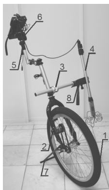
Obr. 7 – Měřící kolo s měřící sondou – 1 - silniční kolo a 2 - systém měřící vzdálenost, 3 - držák skeneru Typ 11/12, 4 - snímač typu 11/12, 5 - rukojeť: 6 - držák měřícího zařízení, 7 - skládací stojan, 8 - univerzální hlavy.
