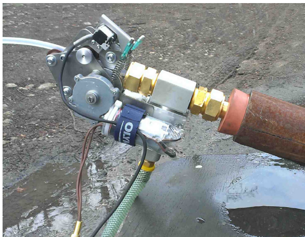
Obr.14 Hlavice umožňující kontrolovaný pohyb systému IRIS
