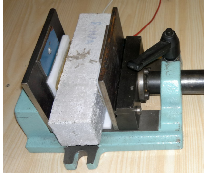
Obr. 2 Uchycení vzorku v přípravku mezi mosazné elektrody o ploše 7x3,5 cm Fig. 2 Fixation of the sample in the brass electrodes with an area of 7x3,5 cm
