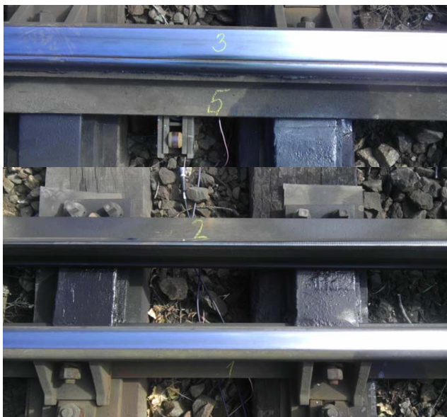
Obr. 2 Umístění snímačů na výhybce, vlaky přejížděly zleva doprava Fig. 2 Location of sensors on the turnout, train driving from left to right
