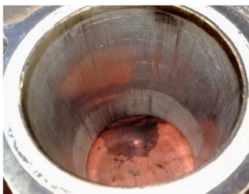
Obr. 6 Pracovní plocha válcové vložky; The working surface of a cylinder
