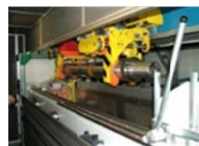
Obr. 4 – Zavážení nápravy manipulátorem
