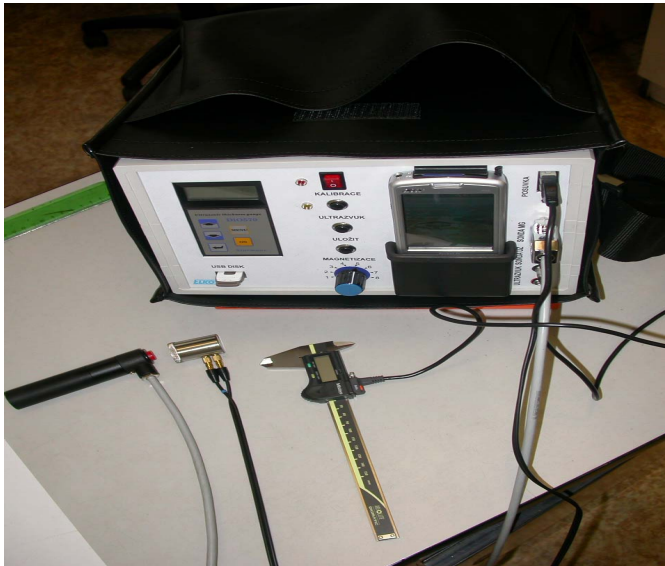
Obr.1. Kombinovaný strukturoskop TELIT se snímači (odleva) Hr, Lu, L.Vynález UV 17830.
