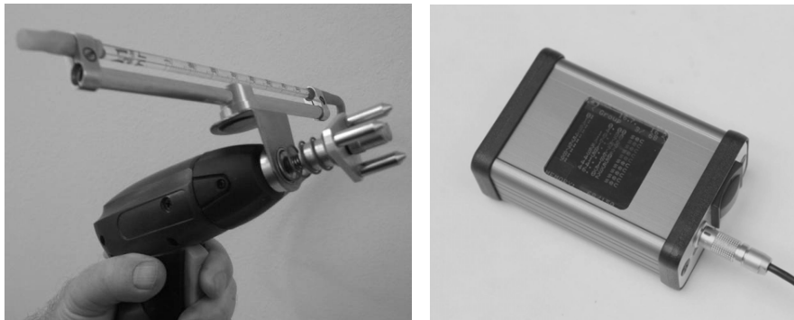
Obr.1 a) Tělo zařízení s mikrotrubicí a hlavní naplněnou cigaretovým filtrem; b) kovová krabička s pamětí
