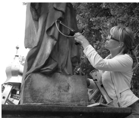
Obr. 2 In situ měření nasákavosti; a) fasáda v Kőszegu, Maďarsko; b) socha anděla posledního soudu v Pomezí, Česká republika
