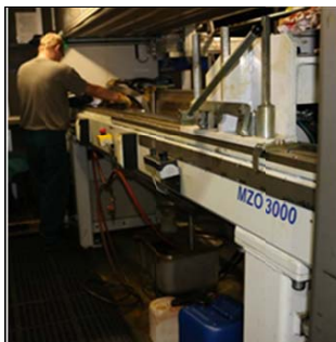
Obr. 1 – Magnetizační zařízení MZO 3000 pro zkoušení železničních náprav
