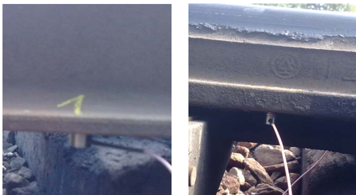
Obr. 3 Vlevo snímač 1 na pravé opornici, vpravo snímač 5 na levém jazyku Fig. 3 Sensor 1 on right stock rail (left), sensor 5 on left switch blade (right)
