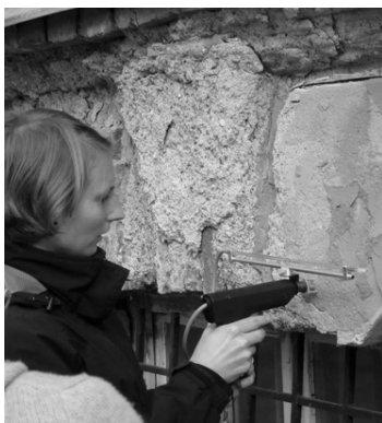
Obr. 2 In situ měření nasákavosti; a) fasáda v Kőszegu, Maďarsko; b) socha anděla posledního soudu v Pomezí, Česká republika
