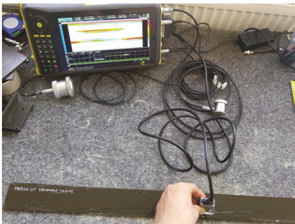
Obr. 10 Měření kompozitního vzorku s delaminací pomocí Phased Array
