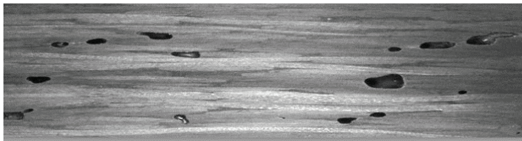
Obr. 4 Porozita v kompozitu
