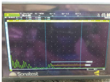
Obr. 14 Měření 10 % porozity konvenčním ultrazvukovým zkoušením
