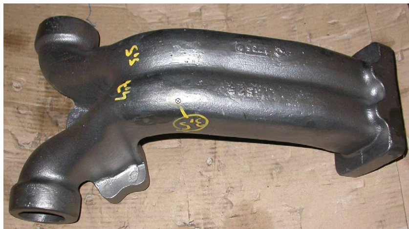
Obr. 3. Příklad odlitku výfukového potrubí o hmotnosti cca 15 kg se zaměřeným neshodným minimem L stěny.
