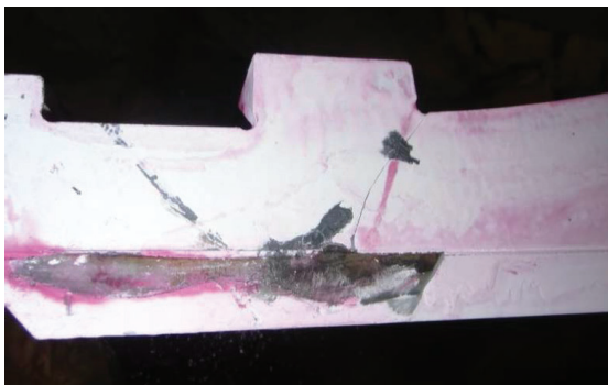
Obr. 2 Výsledek kapilární zkoušky
