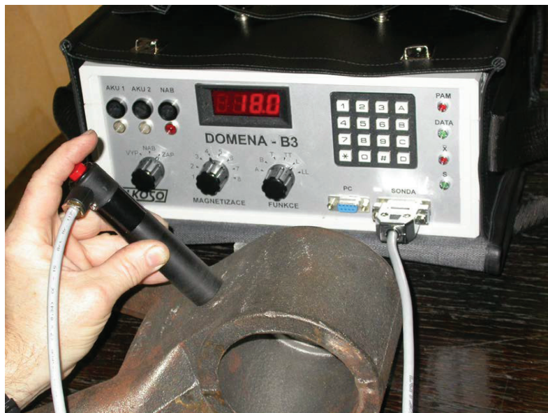
Obr. 2. Strukturoskop DOMENA B3 při měření tvrdosti odlitku (takt 3s). Fig. 2. Structuroscope DOMENA B3 at metering hardness cast (time 3s)
