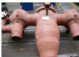
Obr. 10 Kontrola svaru ventilu
