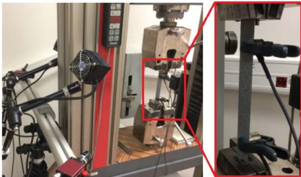
Obr. 1 Experimentální sestava: vlevo – optický stereovizní systém, vpravo – umístění snímačů AE [Autor]
