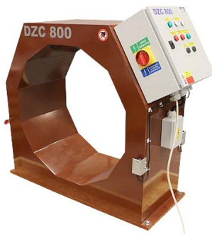
Obr. 15.2 Demagnetizační cívka do linky, vnitřní průměr 800mm, intenzita magnetického pole ve středu cívky je 6,8kA/m při frekvenci 50Hz
