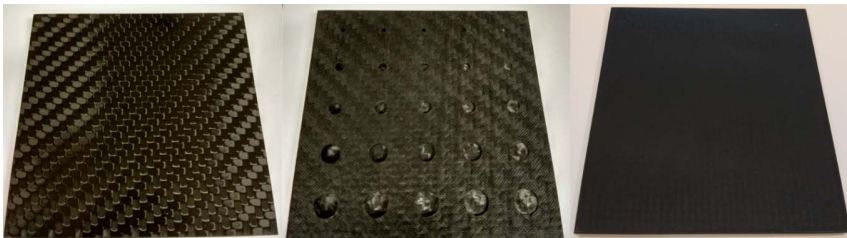
Obrázek 3: Obrázky, materiál CFRP, vpravo vrstva nastříkaná sprejem Thermaspray 800
