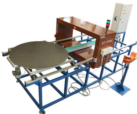
Obr. 15.3 Demagnetizační tunel DT-1300F, Zdroj s frekvenčním měničem, cívka světlost 1300 x 550 mm, intenzita magnetického pole ve středu cívky je 9,1kA/m při frekvenci 30Hz
