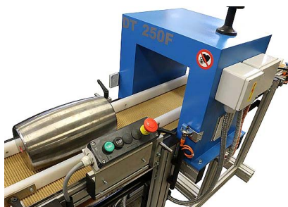
Obr. 15.1 Demagnetizační tunel DT-250F, Zdroj s frekvenčním měničem, cívka světlost 250x250 mm, intenzita magnetického pole ve středu cívky je 44,1kA/m při frekvenci 25Hz (PTS comp.)
