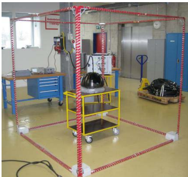
Obr.10.2 Triaxiální uspořádání Helmholtzových cívek
