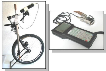
Obr. 2.1 – Snímání magnetického pole nad potrubím v zemi v ose potrubí
