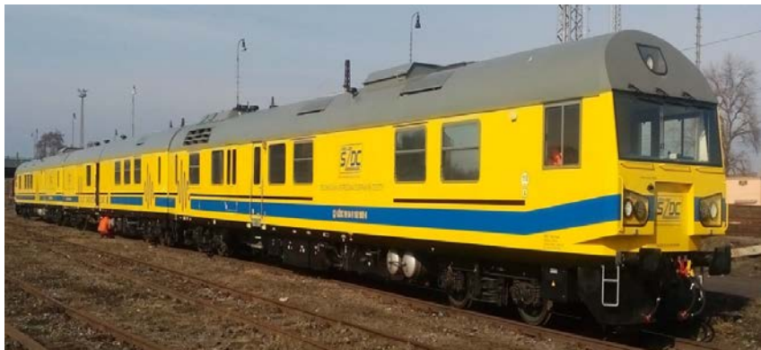
Diagnostická jednotka pro nedestruktivní kontrolu kolejnic Diagnostic unit for non-destructive control of rails
