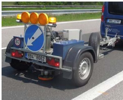
Obr. 2: Rázové zařízení FWD pro měření průhybů vozovek, zdroj: CDV
