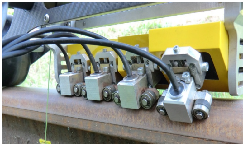
ET – umístění měřících snímačů ET - location of measuring sensors
