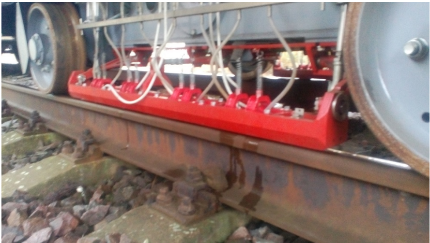
Systém ultrazvukové kontroly kolejnic na měřícím podvozku Ultrasound track inspection system on the measuring chassis
