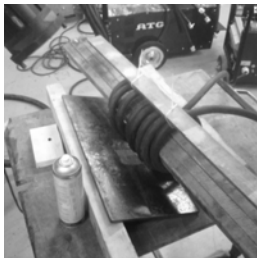
Obrázek 6 – Podélná magnetizace příložnou cívkou [7].
