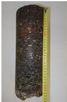
Obr. 6 Jádrový vývrt, zdroj: CDV
