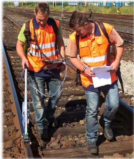
Pochůzková kontrola ručními defektoskopickými přístroji Hand inspection by hand defectoscopy devices
