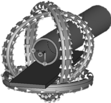
Obrázek 13 - Numerický model soustavy cívek s trubkou [7].
