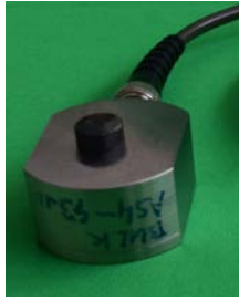
Obr. 2: Detail na míru vyrobeného držáku vzorku s vestavěným snímačem akustické emise a příkladem na něm nalepeného vzorku (v tomto případě se jedná o bulkový vzorek, ne o tenkou vrstvu).
